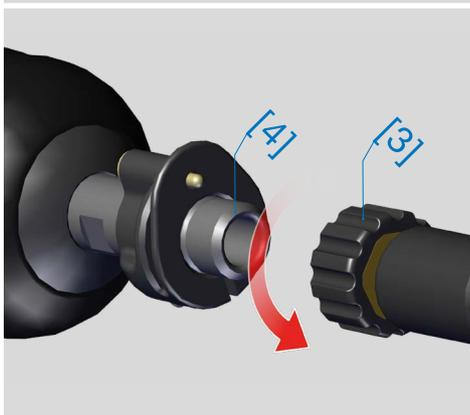
Montaje de la tapa de protección roscada
