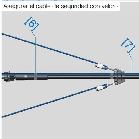
Asegurar el cable de seguridad con velcro
